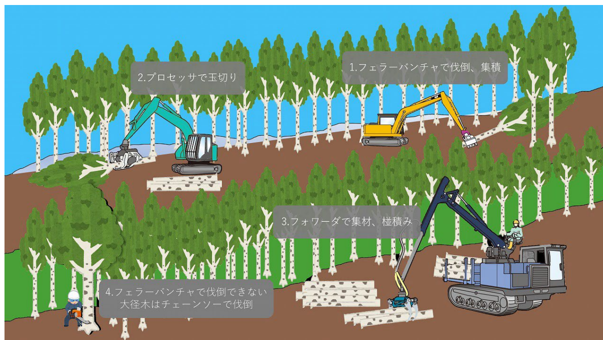
図2 高性能林業機械を活用した間伐作業における作業フロー
